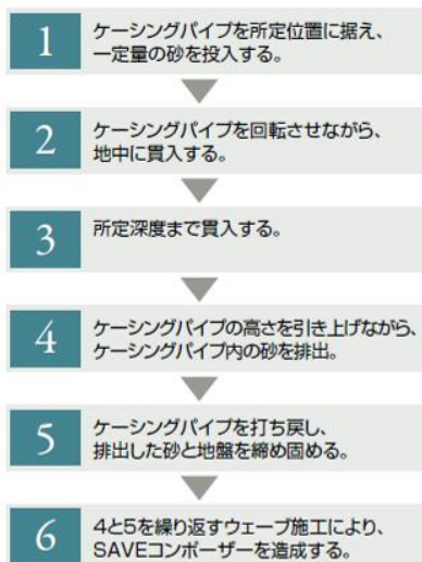
静的締固め砂杭工法概念図
